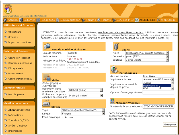
Détail de la configuration du poste client. La configuration vidéo, l'imprimante par défaut et la licence Windows sont importantes pour le déploiement.
